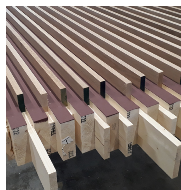
Dekkeelement med ribber i eik og malt gran.
